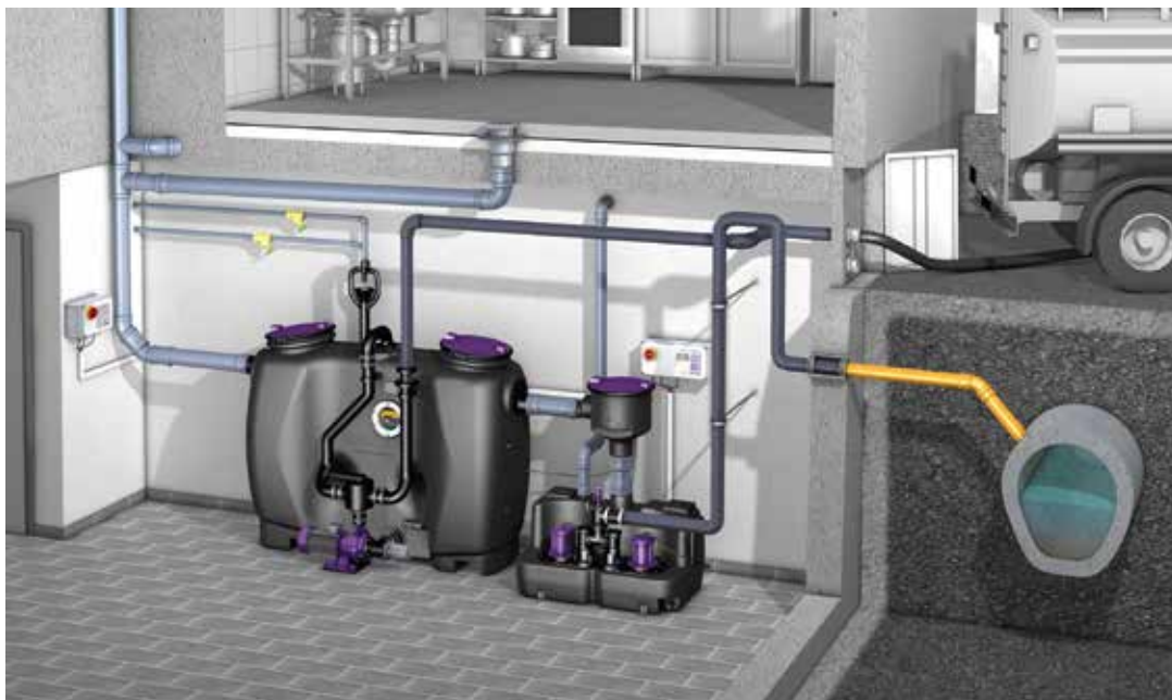
Beispieleinbaubild Fettabscheider EasyClean PVS
