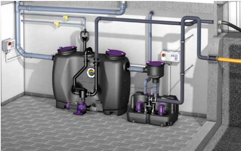
Einbausituation Fettabscheider EasyClean free Mix & Pump
