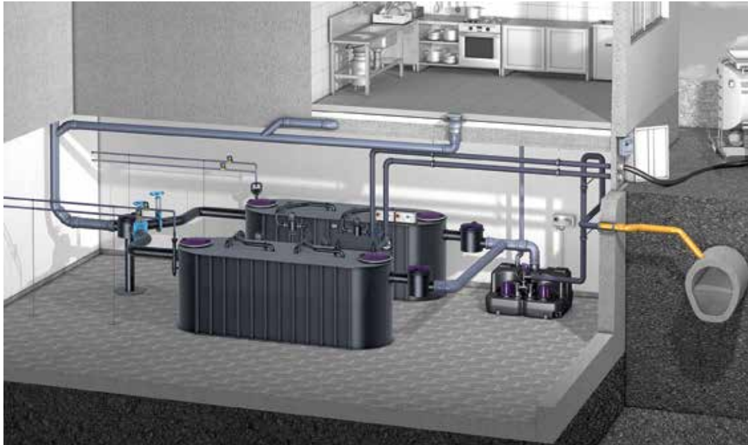
Einbaubeispiel Fettabscheider EasyClean free Auto Mix & Pump NS 30
